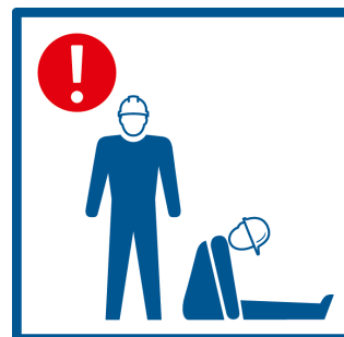
Der Aufenthalt in durch tiefkalte Gase unterkühlter Luft kann zur Unterkühlung des Körpers führen, bzw. zu Störung der Lungentätigkeit beim Einatmen dieser Luft.
